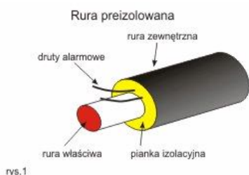
(rys 1: Budowa rury preizolowanej)
